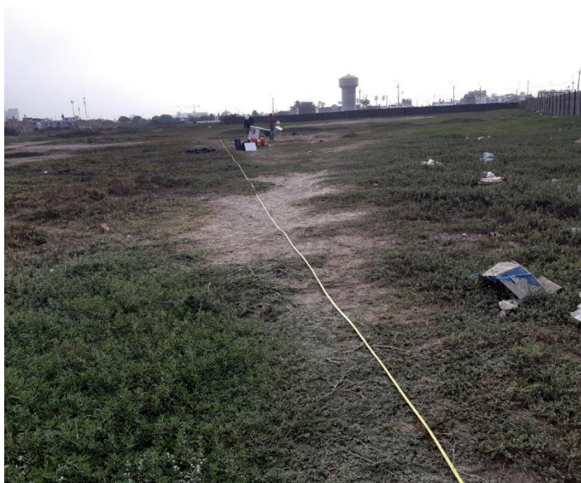
Figura 4.3. Ejemplo de medición de cada línea sísmica con cintra métrica y ubicación de geófonos.
