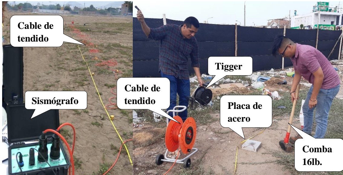
Fotografía 4.1. Equipos empleados en campo para el ensayo de refracción sísmica
