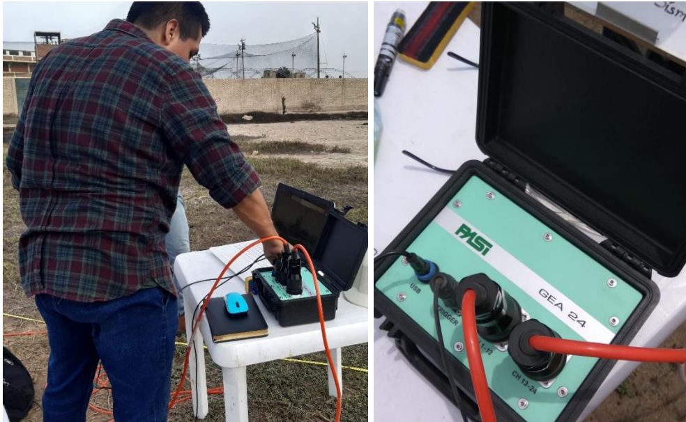
Fotografía 4.6. Conexión de cable de refracción, tigger y portátil.
