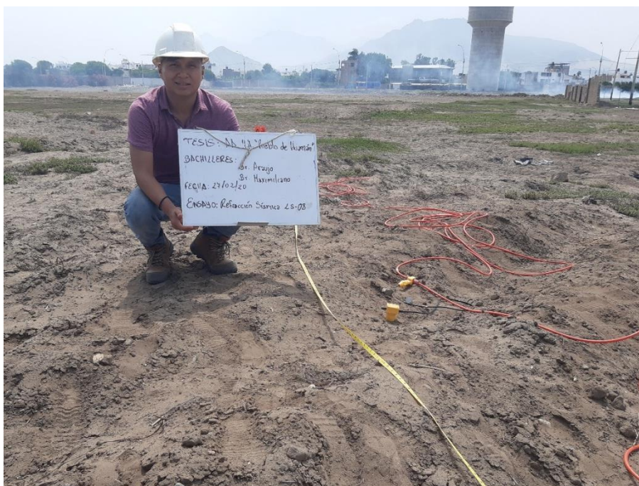
Fotografía 6. Línea sísmica LS-08 llevada a cabo el 27 de febrero de 2020 en el Asentamiento Humano “Pueblo de Huamán”.
