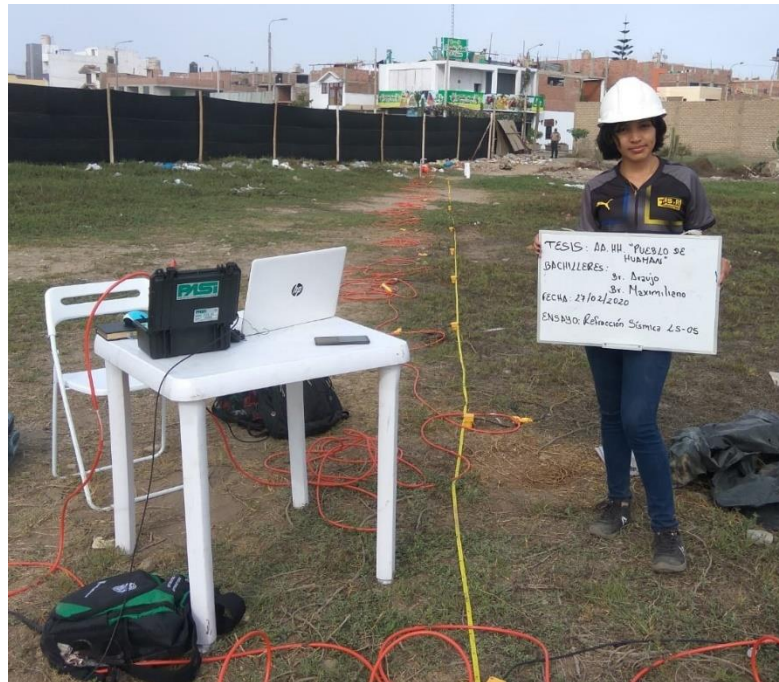
Fotografía 3. Línea sísmica LS-05 llevada a cabo el 27 de febrero de 2020 en el Asentamiento Humano “Pueblo de Huamán”.
