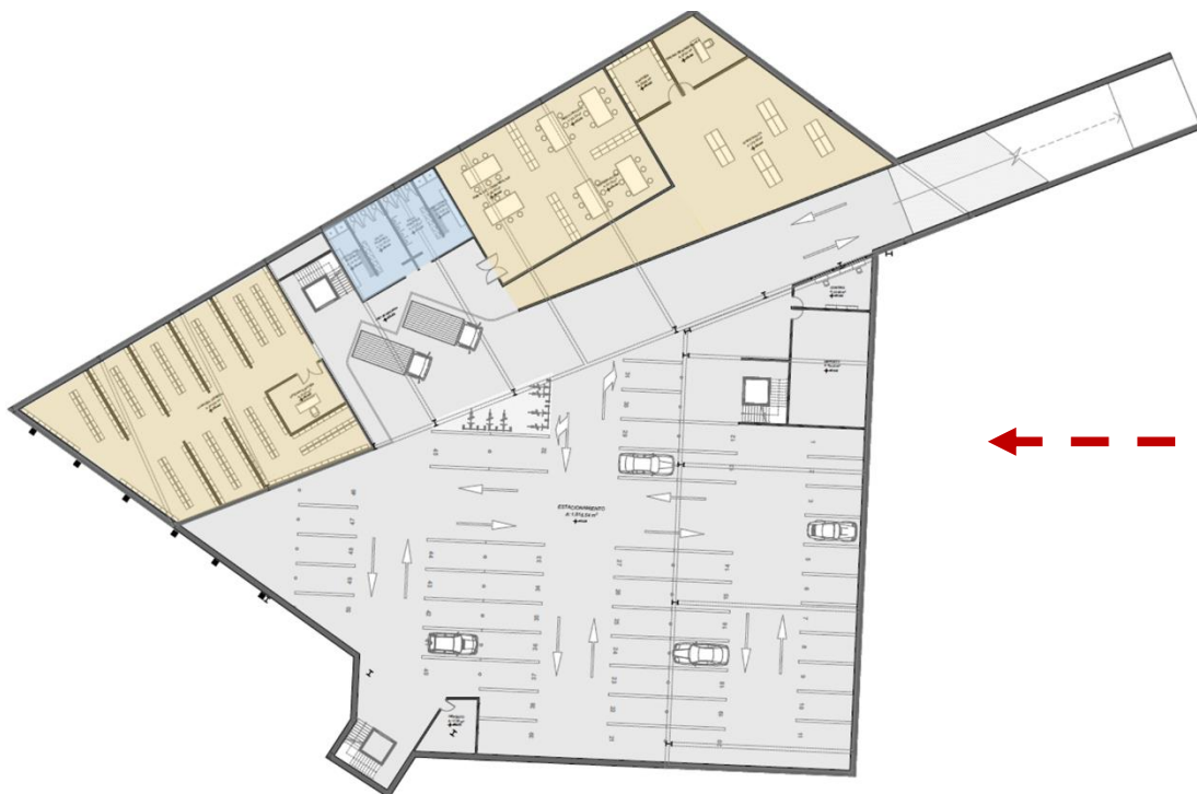
Figura CLXVI. Plano de distribución del sótano
