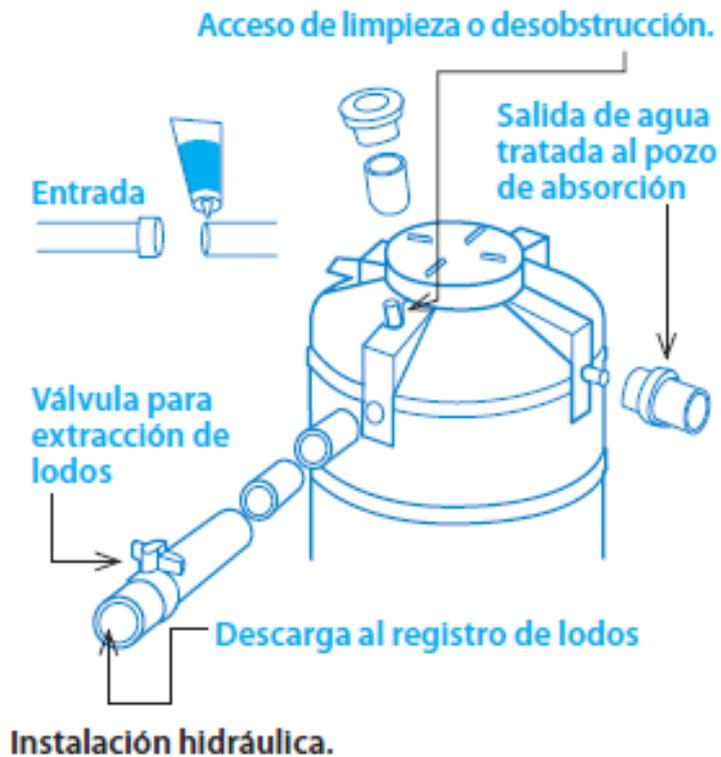
Imagen 10: Instalación Hidráulica del biodigestor
