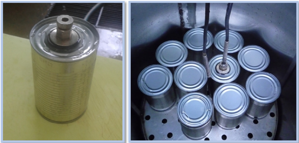
Figura C. Sensores para medir la temperatura en el interior de la lata y en el autoclave.
