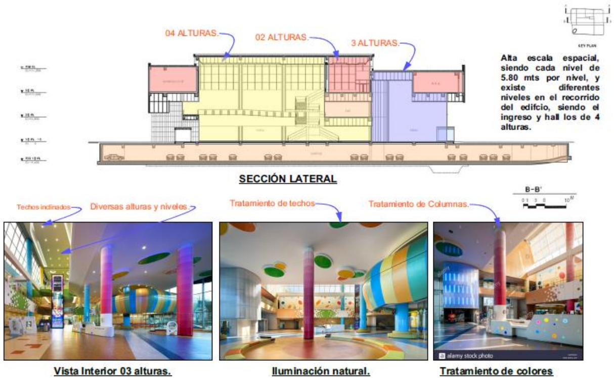
FIG. N° 45. Análisis Alturas Museo de la ciencia para Niños de Incheon Fuente: Elaboración Propia
