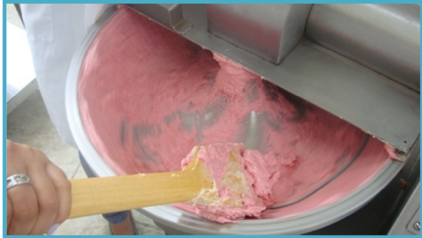
Figura E. Emulsificación de la masa
