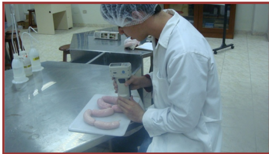
Figura J. Análisis de color instrumental de la salchicha tipo Frankfurter
