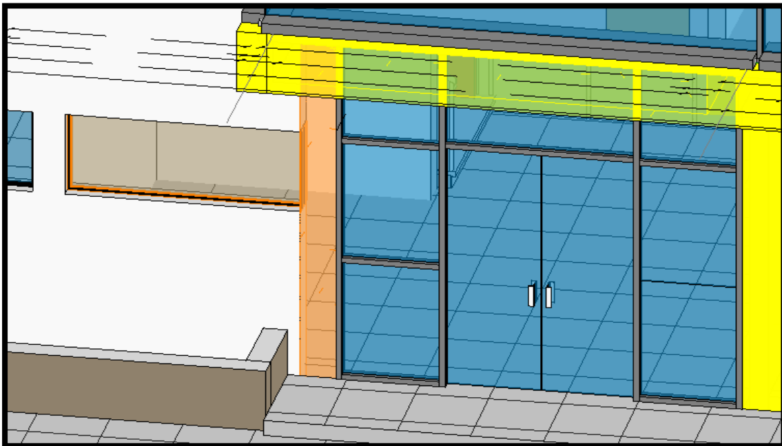
Fig. 17. Ventanas que no consideran la ubicación de las columnas
