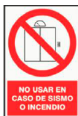
Imagen N° 119 Uso prohibido en caso de sismo o incendio
