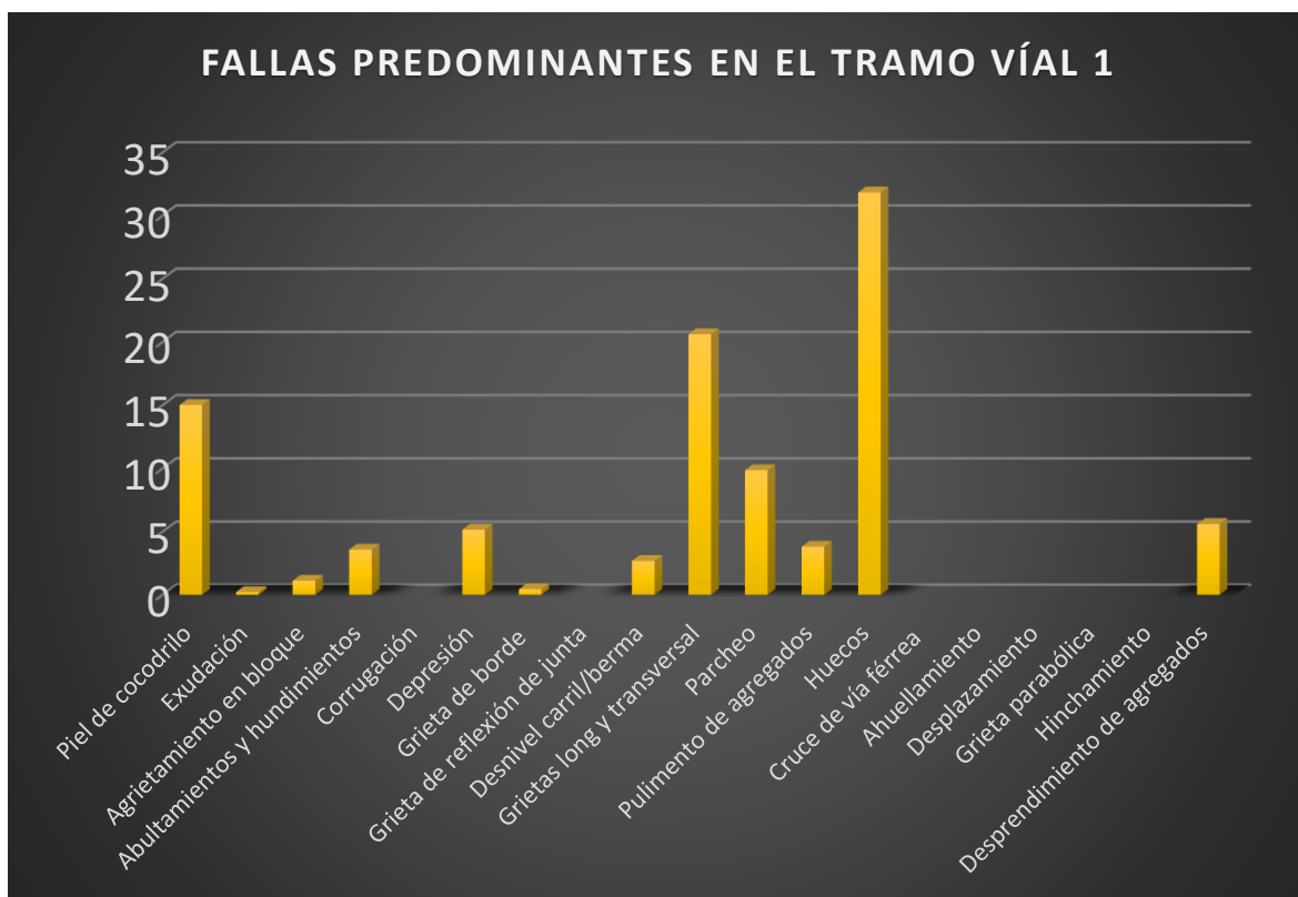
Gráfico 1 Fallas predominantes en el tramo 1
