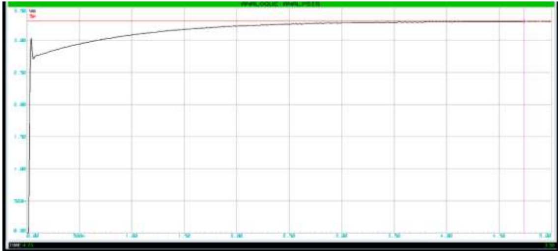
Figura 20. Respuesta a una excitación de 3.3v con T_s=8,0384 ms. Fuente Elaboración propia
