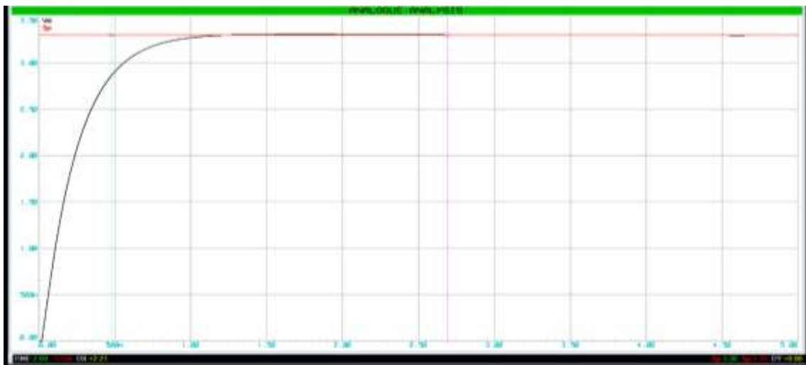
Figura 17. Respuesta a una excitación de 3.3v con T_s=10.0352 ms. Fuente Elaboración propia
