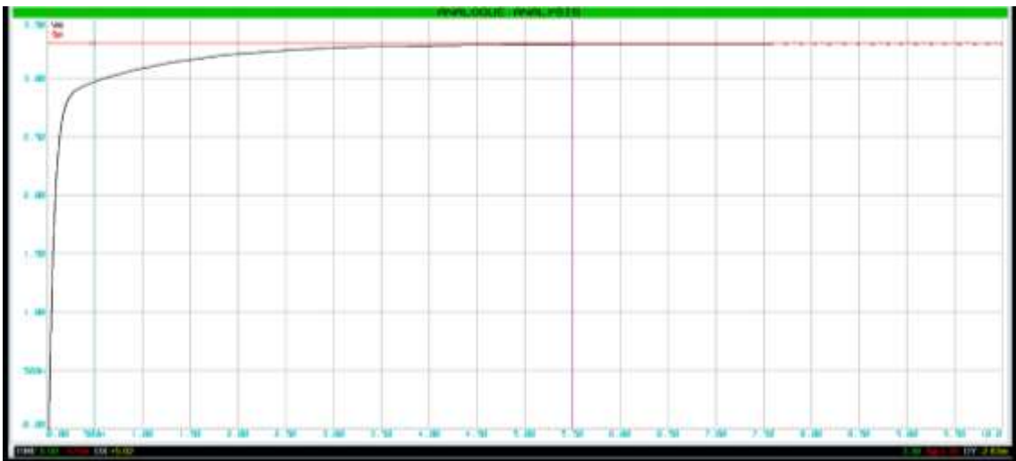
Figura 9. Respuesta a una excitación de 3.3v con T_s=10,0352 ms. Fuente Elaboración propia
