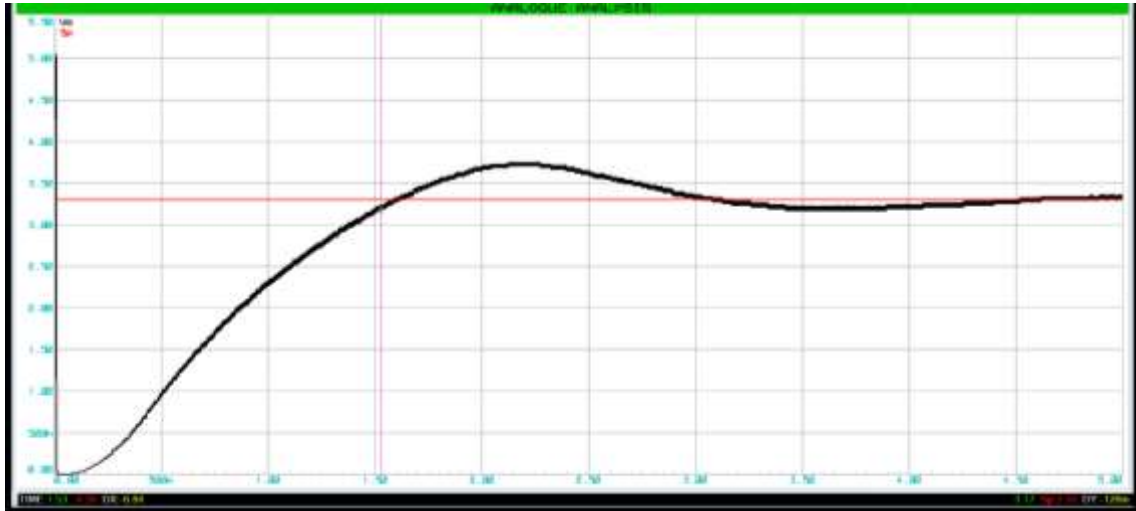
Figura 34. Respuesta a una excitación de 3,3v con T_s=4,0448 ms. Fuente Elaboración propia
