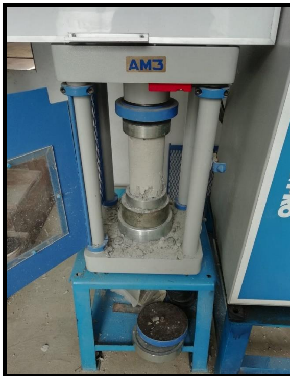
Figura 37. Ensayo de Compresión.
