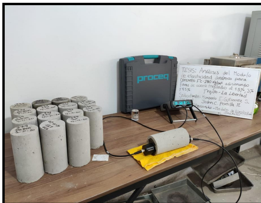
Figura 44. Ensayo de Resonancia con equipo Pundit ® Lab.
