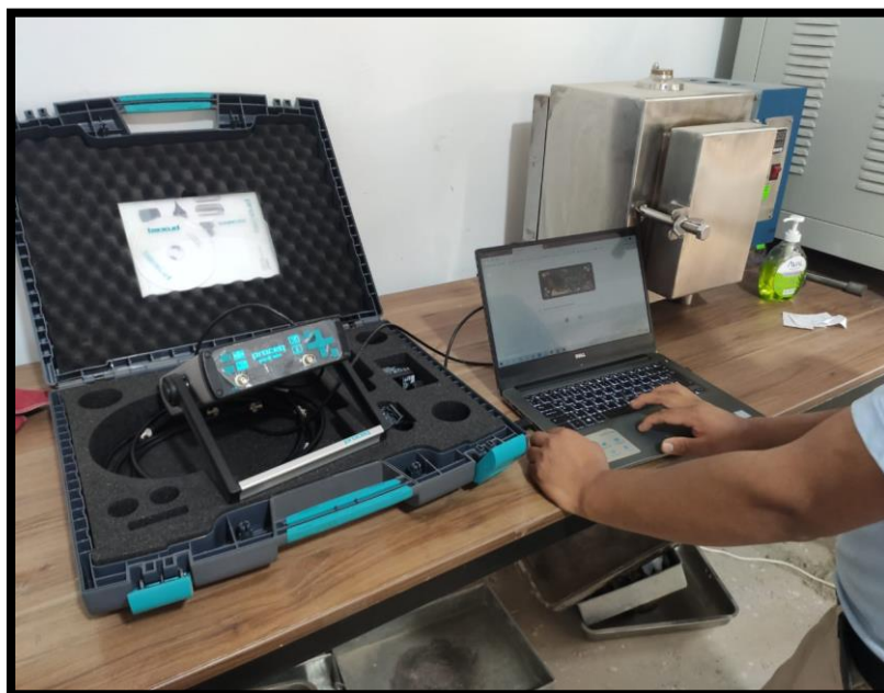
Figura 40. Calibración del equipo Pundit ® Lab.
