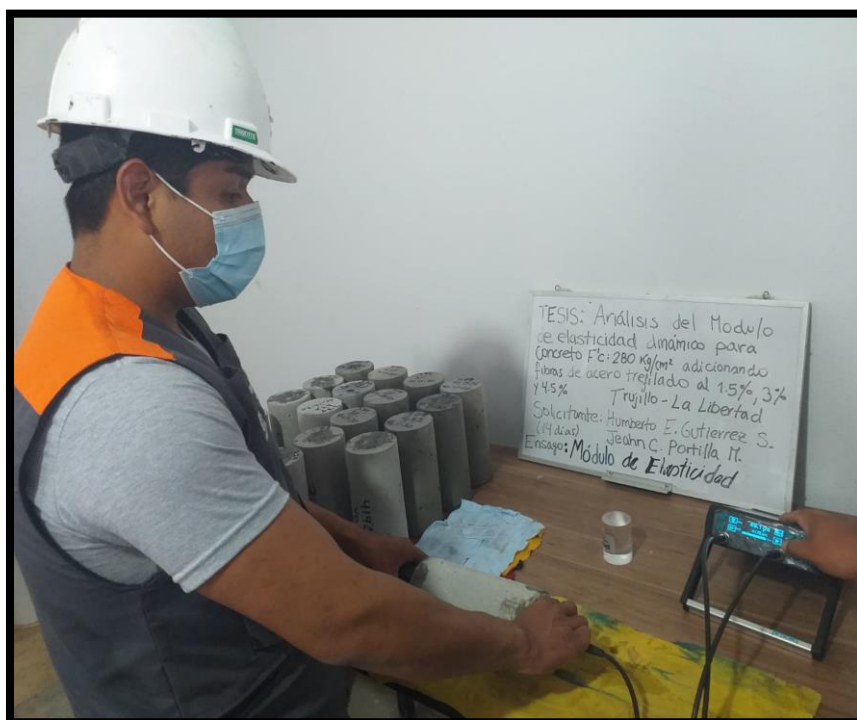
Figura 46. Ensayo de Resonancia con equipo Pundit® Lab.
