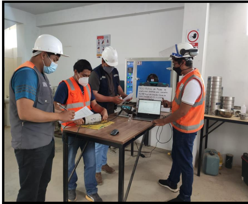
Figura 49. Validación de datos con equipo Pundit® Lab.
