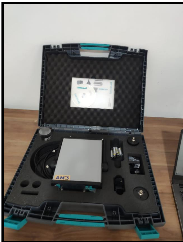
Figura 39. Equipo de resonancia Pundit ® Lab.
