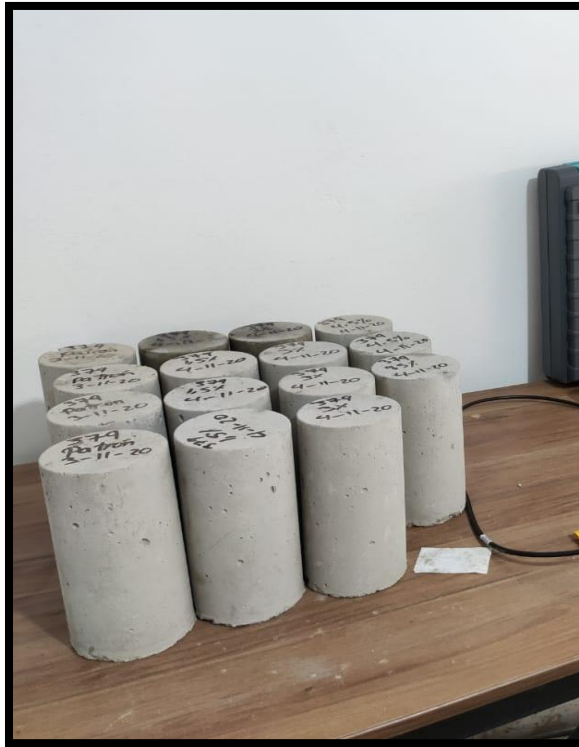
Figura 35. Testigos de concretos para realizar los ensayos.
