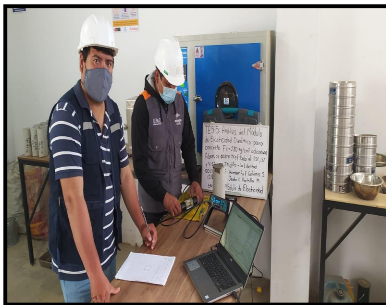
Figura 47. Ensayo de Resonancia con equipo Pundit® Lab.
