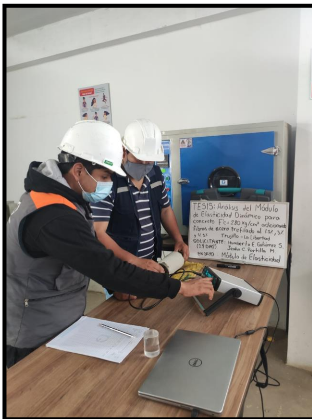
Figura 48. Validación de datos con equipo Pundit® Lab.
