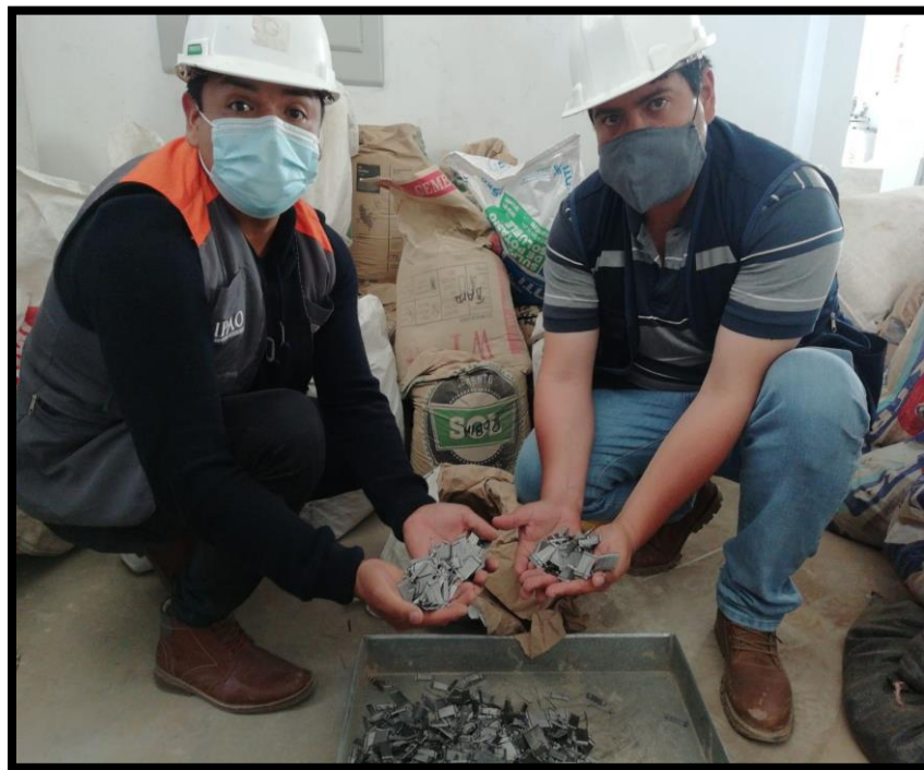
Figura 34. Selección de aditivos de acero trefilado.
