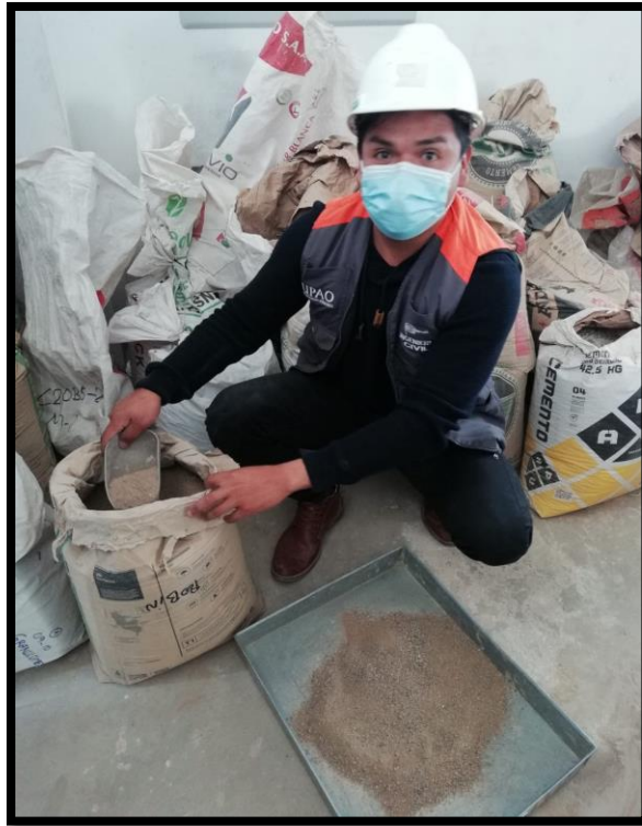
Figura 33. Separación de muestras de agregado grueso.
