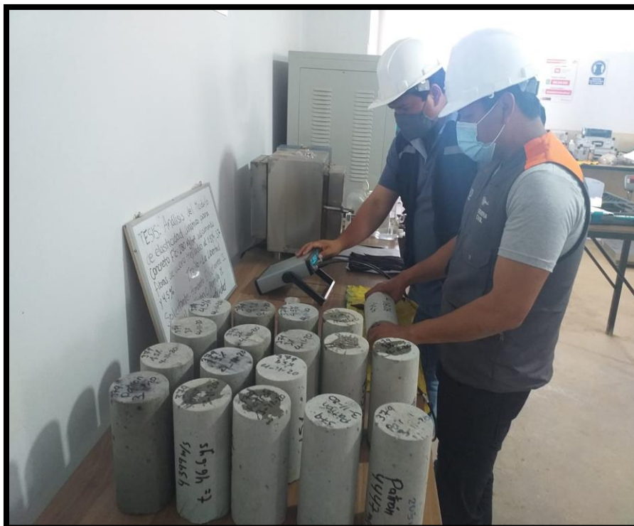
Figura 45. Ensayo de Resonancia con equipo Pundit® Lab.
