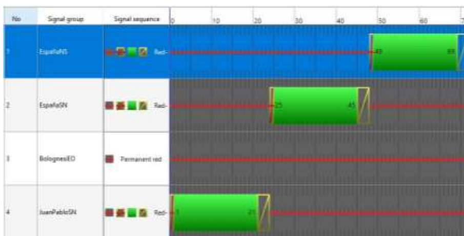
Figura 57: Tiempo de fase de Semáforo. Fuente: Programa Vissim V9
