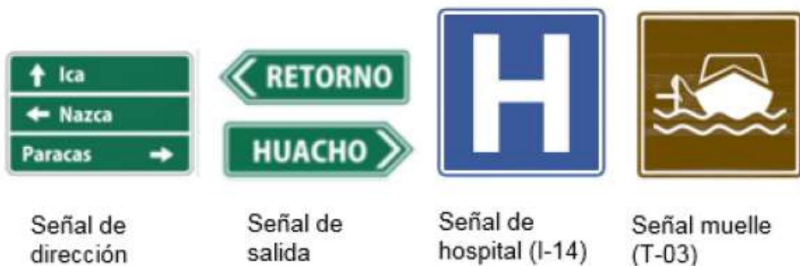
Figura 23: Señales Verticales de Información. Fuente: (Comunicaciones, 2016)
