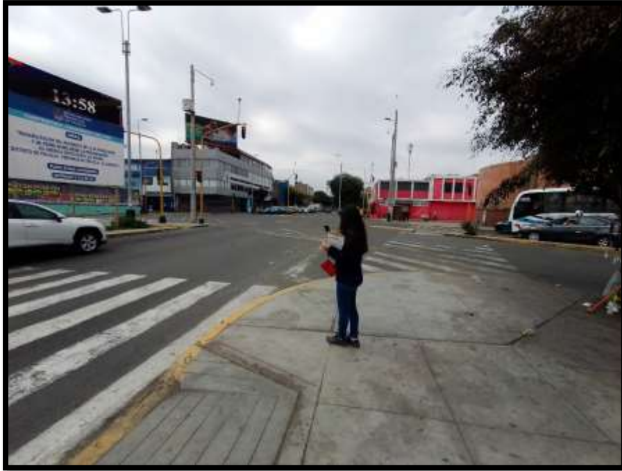
Figura 46": Tomando tiempo del ciclo semafórico
