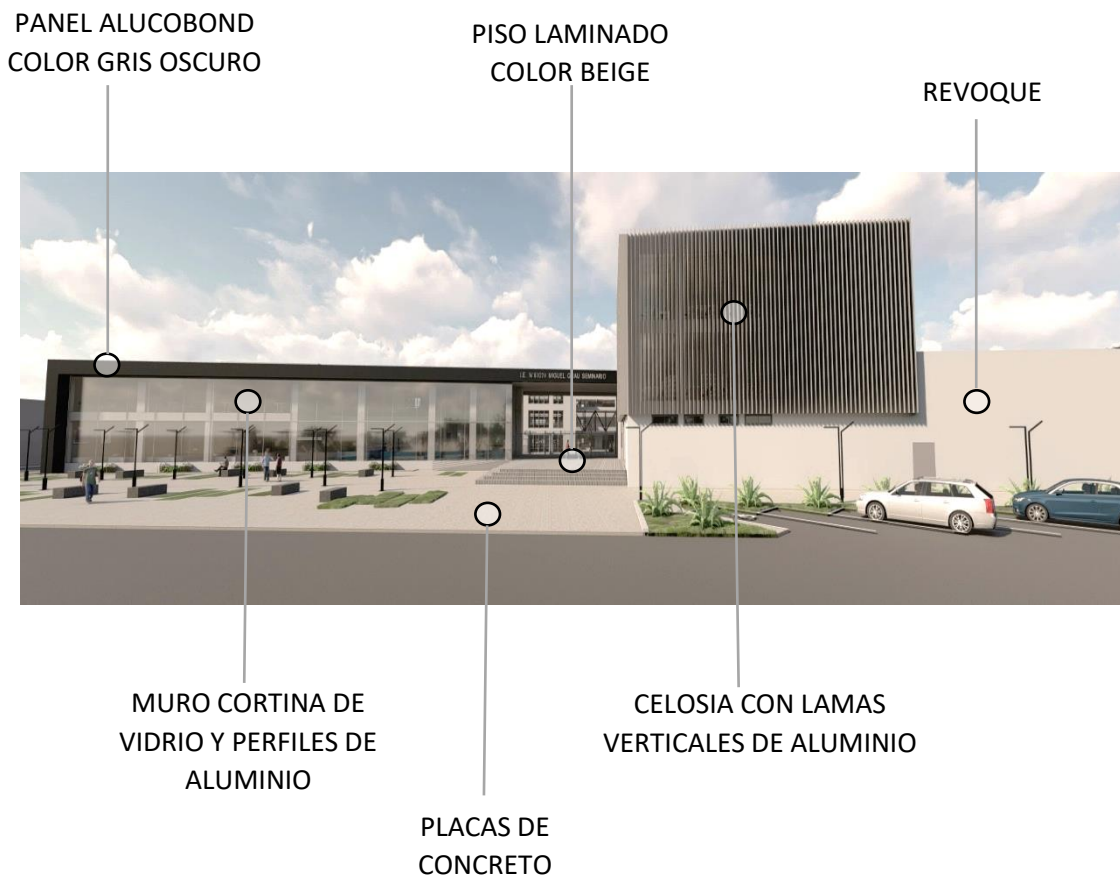
IMAGEN N° 61: 3D FACHADA - MATERIALIDAD FUENTE: ELABORACION PROPIA
