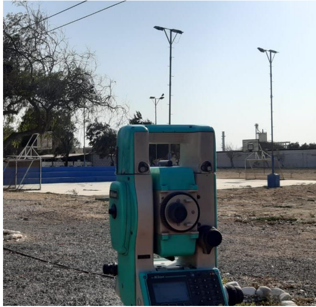
Figura 3 Estación Total Nikon DTM-632
