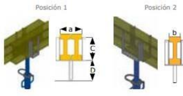
Figura 9: Disposiciones de soporte del cabezal puntal. Fuente: Dacame S.L. (2018).
