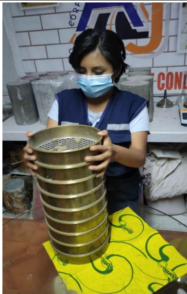
Figura 26. Ensayo de Análisis Granulométrico por Tamizado
