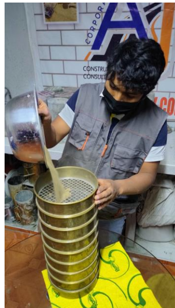
Vertiendo el material a ensayar
