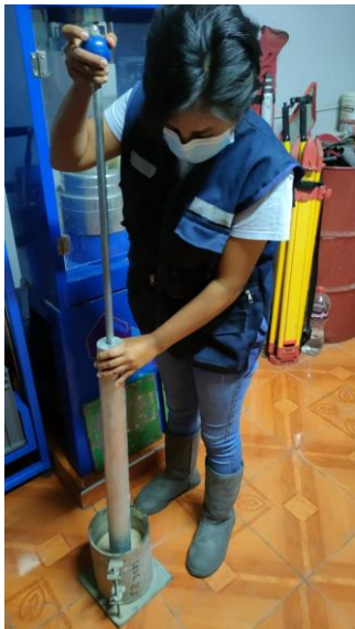
Figura 27. Ensayo de CBR
