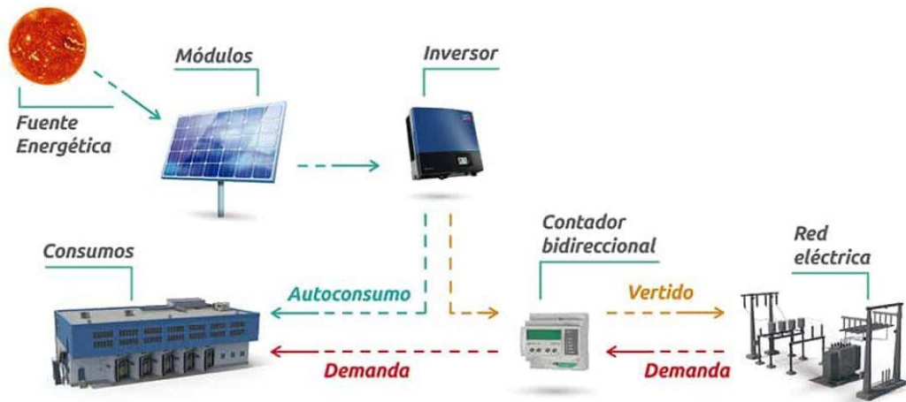
Figura 150. Componentes de un sistema conectado a red
