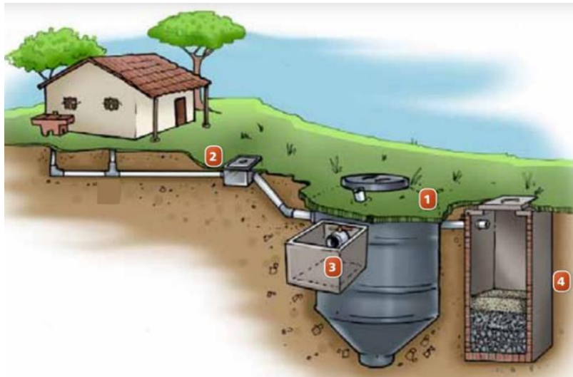
IMAGEN N°08: SISTEMA DE TRATAMIENTO DE AGUAS NEGRAS
