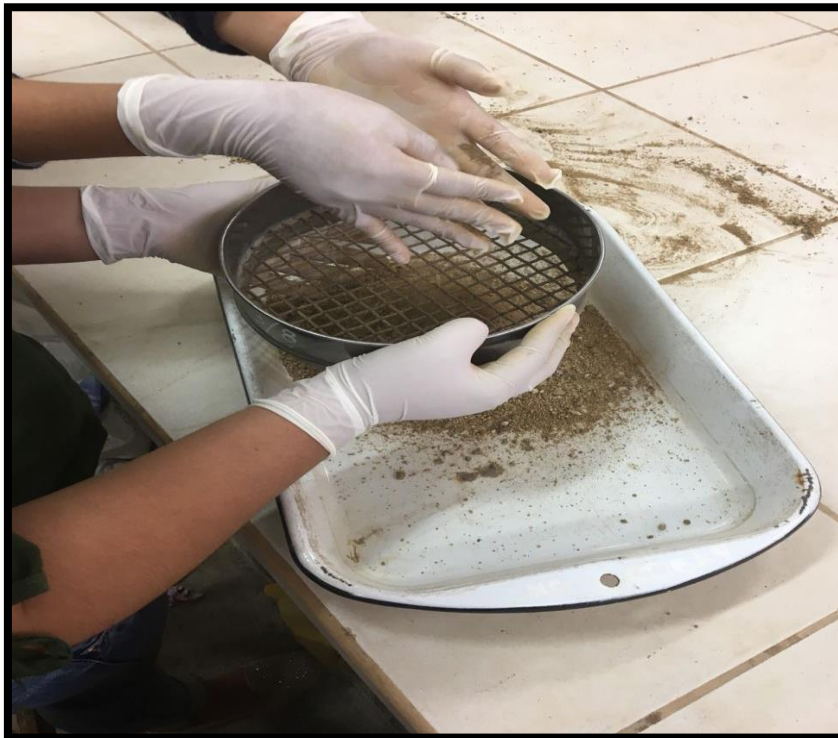
Figura 24 Tamizado de los agregados con ayuda del tamiz.
