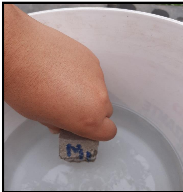
Figura 38 Absorción de la M1 de adoquines modificados con conchas de abanico a escala.
