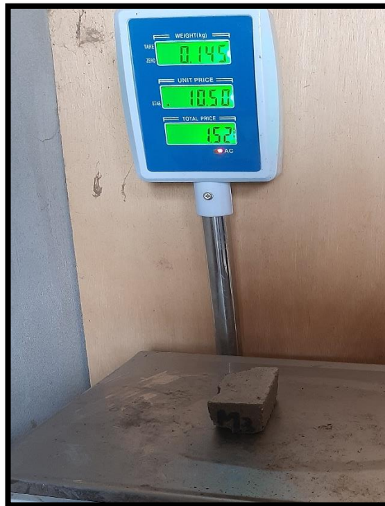
Figura 45 Peso saturado de la M3 de adoquines con conchas de abanico a escala.
