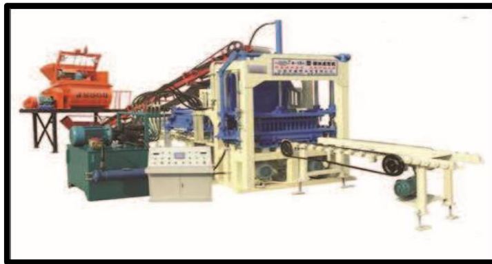
Figura 14: Máquina Automática para la fabricación de adoquines.
