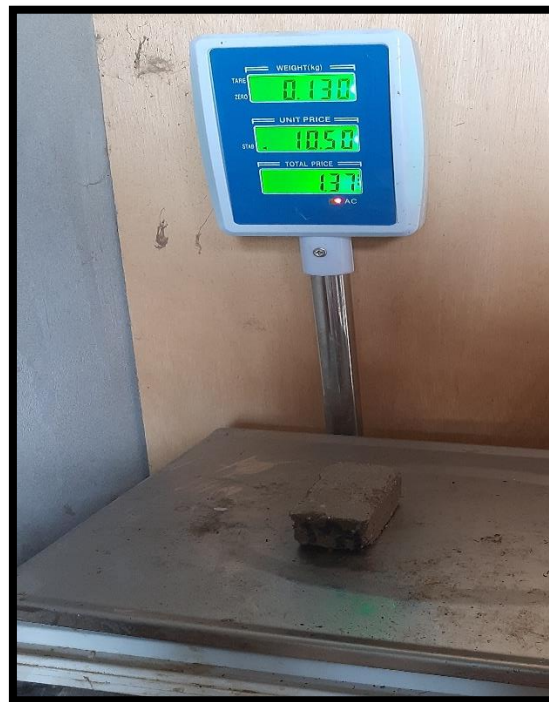
Figura 46 Peso saturado de la M4 de adoquines con conchas de abanico a escala.
