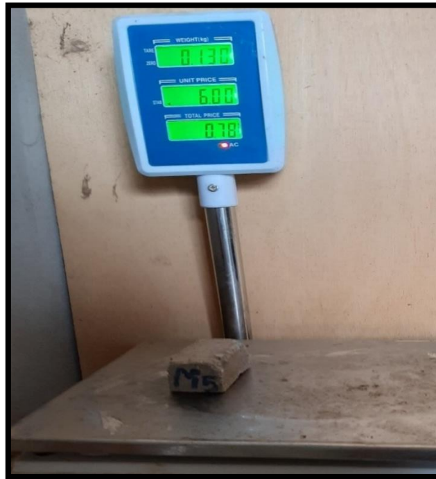
Figura 37 Peso seco de la M5 de adoquines con conchas de abanico a escala.
