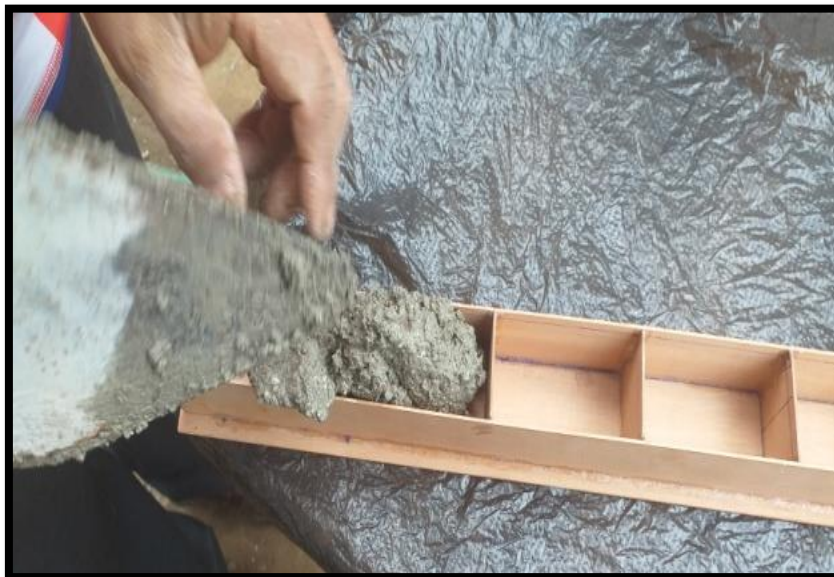
Figura 28 Agregado de la mezcla en el molde.
