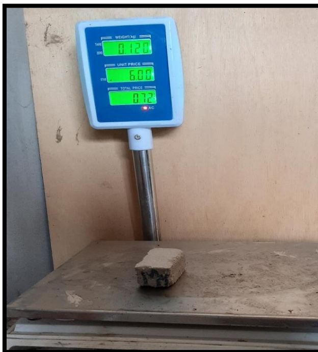
Figura 36 Peso seco de la M4 de adoquines con conchas de abanico a escala.
