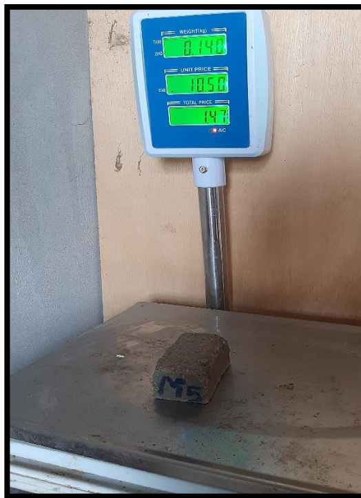
Figura 47 Peso saturado de la M5 de adoquines con conchas de abanico a escala.
