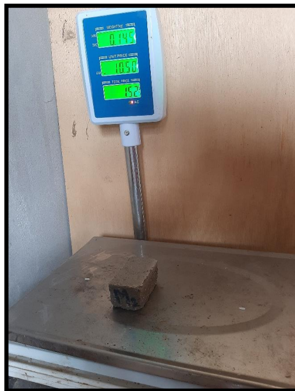
Figura 44 Peso saturado de la M2 de adoquines con conchas de abanico a escala.
