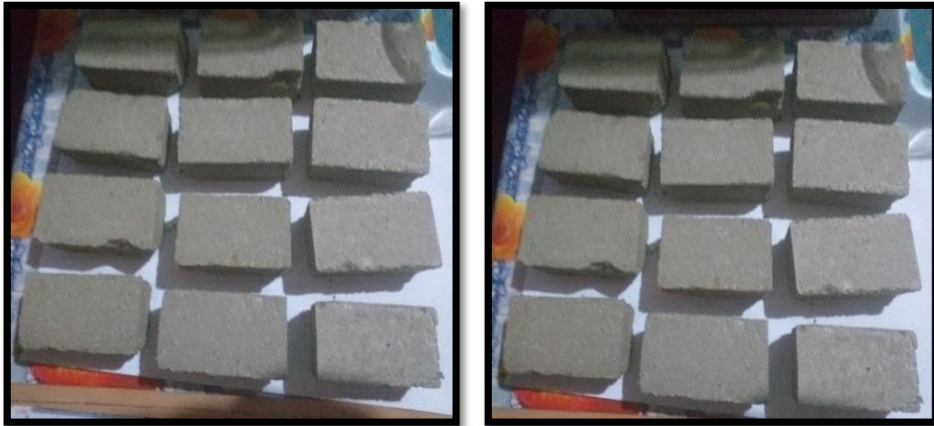
Figura 31 Secado de la muestra de adoquín a escala, a temperatura ambiente, y se hizo el curado durante los primero siete días.
