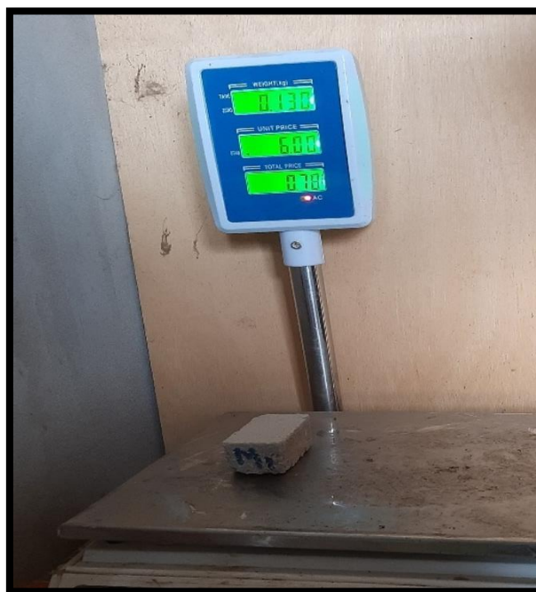
Figura 33 Peso seco de la M1 de adoquines con conchas de abanico a escala.
