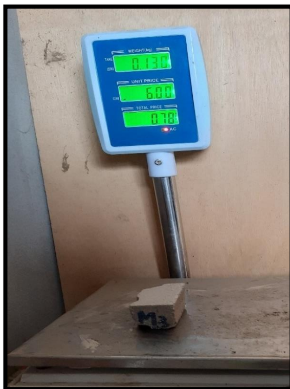
Figura 35 Peso seco de la M3 de adoquines con conchas de abanico a escala.
