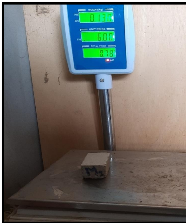
Figura 34 Peso seco de la M2 de adoquines con conchas de abanico a escala.
