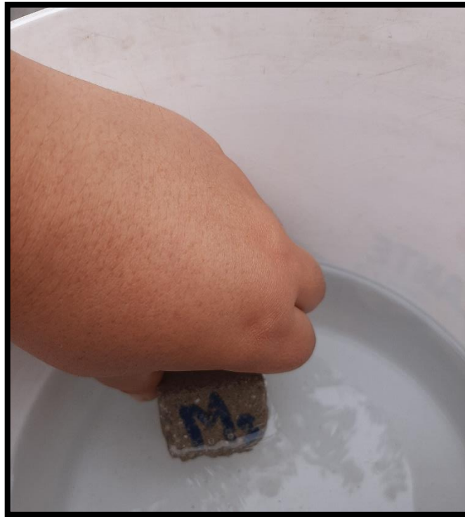
Figura 39 Absorción de la M2 de adoquines modificados con conchas de abanico a escala.
