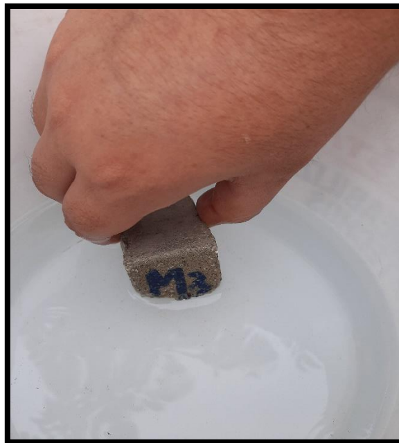
Figura 40 Absorción de la M3 de adoquines modificados con conchas de abanico a escala.
