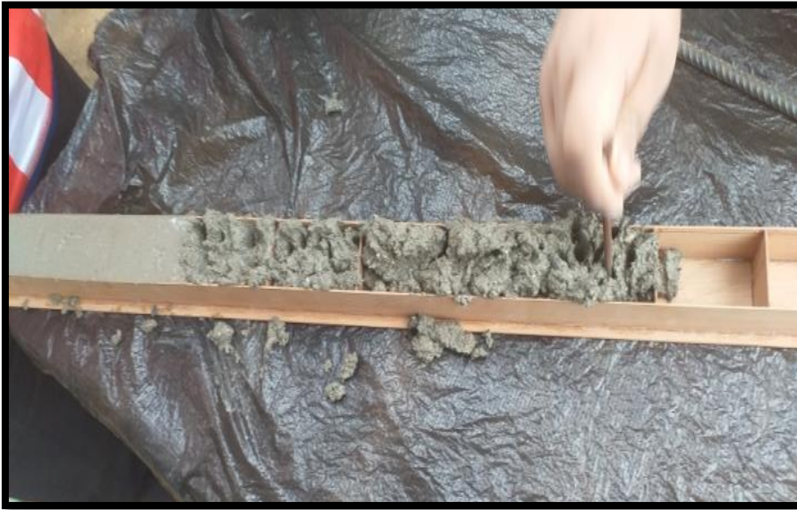
Figura 29 Vibración del concreto, manualmente.
