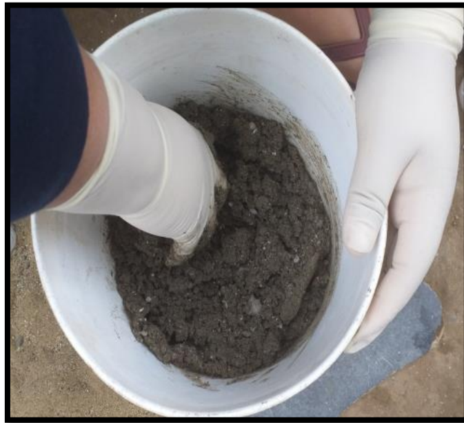
Figura 27 Mezclado de los agregados, para la elaboración del adoquín.
