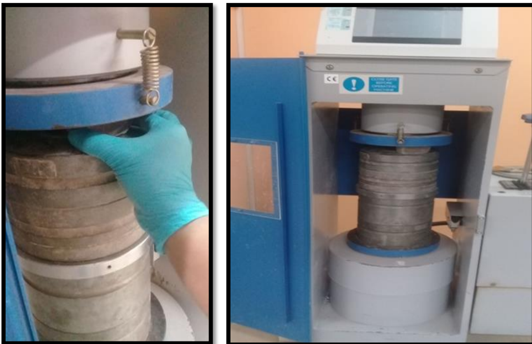
Figura 48 Sometido a la máquina de compresión.
