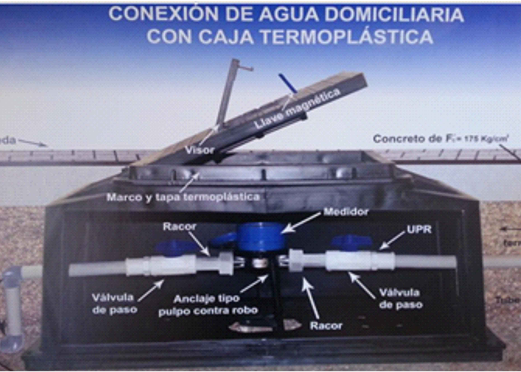
EXISTENTE - MEDIDOR DOMICILIARIO INC. CAJA Y TAPA TERMOPLÁSTICA - CONEXIÓN DE AGUA POTABLE
