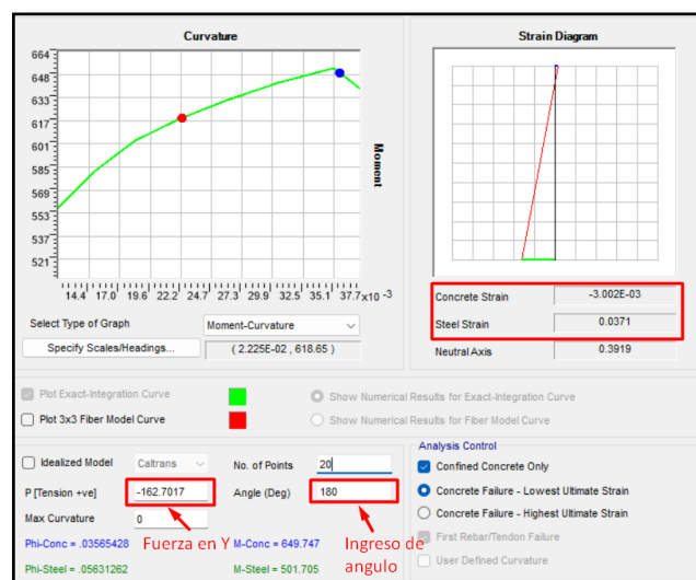
Figura 93. Cálculo de la deformación del acero en Y “↑”
